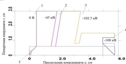
Рис. 2. Аксиально-симметричная ИОС: 1 – резонатор, 2 – извлекающий электрод, 3 – запирающий электрод, 4 – мишень, 5 – выходное отверстие
