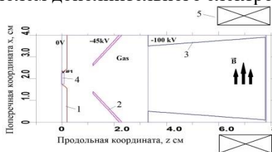
Рис. 1. Плоская ИОС: 1 – резонатор, 2 – извлекающий электрод, 3 – мишень, 4 – выходное отверстие, 5 – подавляющие магниты
